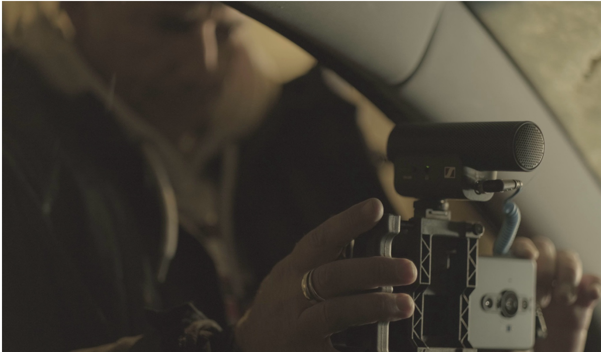
Rayners keuze om de MKE 400 te gebruiken betekent dat één connector verwijderd moet worden, omdat de monitoring nu geleverd wordt via een 3,5mm-jackaansluiting
